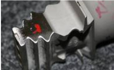
Beispiel: Entgraten einer Turbinenschaufel
