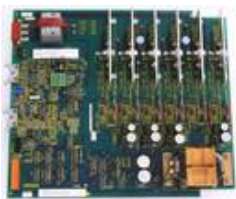
Antriebsplatte Kleine Leistung 1,1 A / 2,1 A
