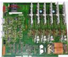
Antriebsplatte Große Leistung 25 A
